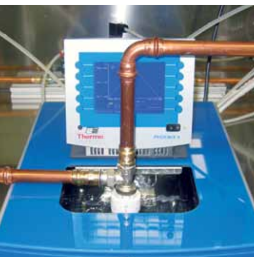
Stazione collaudo teste termostatiche
